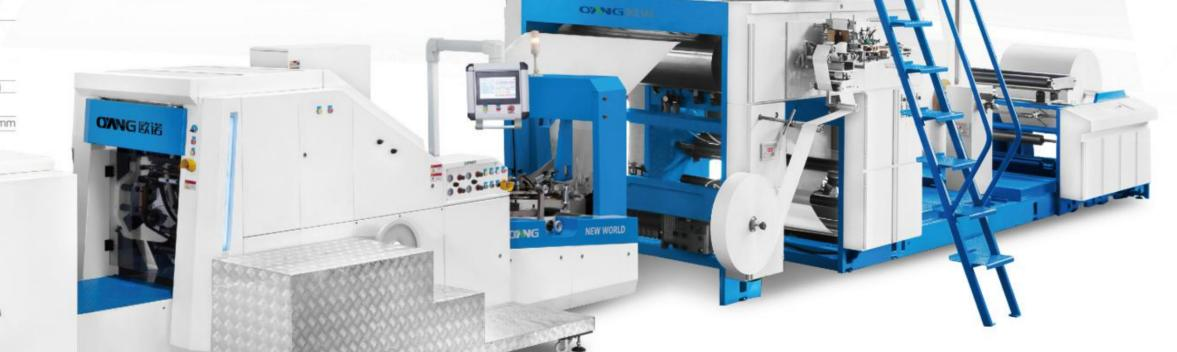
通过直接在纸面上制作扁绳手把,客户不仅可以不再依赖传统的外置手把机,而且可以节省50%的贴片纸张。 此外,在同一台机器上可以实现扁绳内折或外翻,帮客户在传统用袋习惯和高效包装运输之间找到完美平衡。
