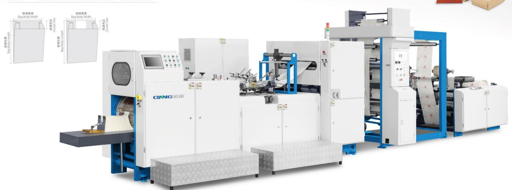
本机用于卷简原色纸或印刷卷筒纸,如牛皮纸、油光纸、医用纸等,纸卷由纸袋工艺刺孔、中锋上胶、色标定长、原料成筒、定长撤断、底部折底、底部上胶。
